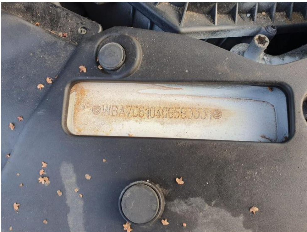
Fot. 7. Numer identyfikacyjny - ZAFALSZOWANY!
